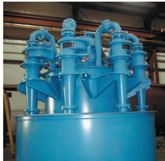
Powyżej: Hydrocyklony klasyfikujące ziarna kamienia wapiennego w instalacjach odsiarczania spalin w elektrowniach węglowych
