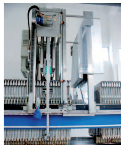
Urządzenie zgarniające z płukaniem tkanin filtracyjnych
